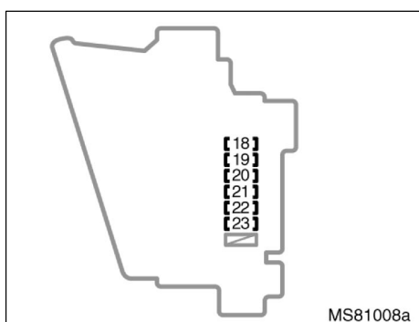
Bloque de empalmes del panel de instrumentos (lado izquierdo)
