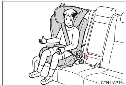
Achten Sie darauf, dass der Schultergurt ordnungsgemäß über die Schulter des Kindes verläuft und dass der Beckengurt so tief wie möglich liegt. (→S. 38)
